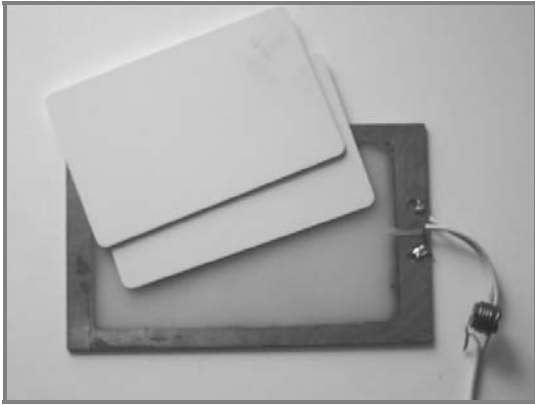
Fig. 3. Antena del módulo lector y tarjetas RFID (transponder).
