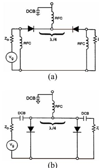
Fig. 13. Conmutador sintonizado (a) serie y (b) paralelo [6].
