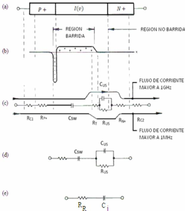
Fig. 4. Circuito Equivalente de un diodo p-i-n en polarización Inversa. (a) modelo del diodo p-v-n, (b) zona de agotamiento antes del voltaje de perforación, (c) circuito equivalente detallado, (d) circuito equivalente a bajas frecuencias, (e) circuito equivalente para microondas [1].
