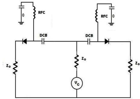
Fig. 9. Conmutador SPDT [6]
