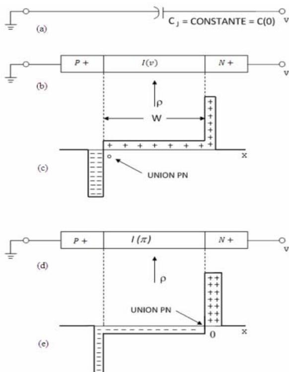
Fig. 2. Perfiles de los dos tipos de diodo *p-i-n*. (a) capacitancia aproximada de circuito equivalente, (b) cristal *p-v-n*, (c) perfil de impurezas *p-v-n*, (d) cristal *p- $\pi$ -n*, (e) perfil de impurezas *p- $\pi$ -n* [1].
