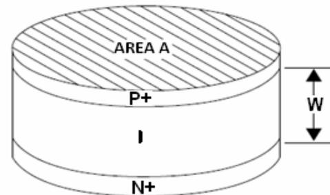
Fig. 1. Diagrama de un diodo  $p-i-n$  [6].
