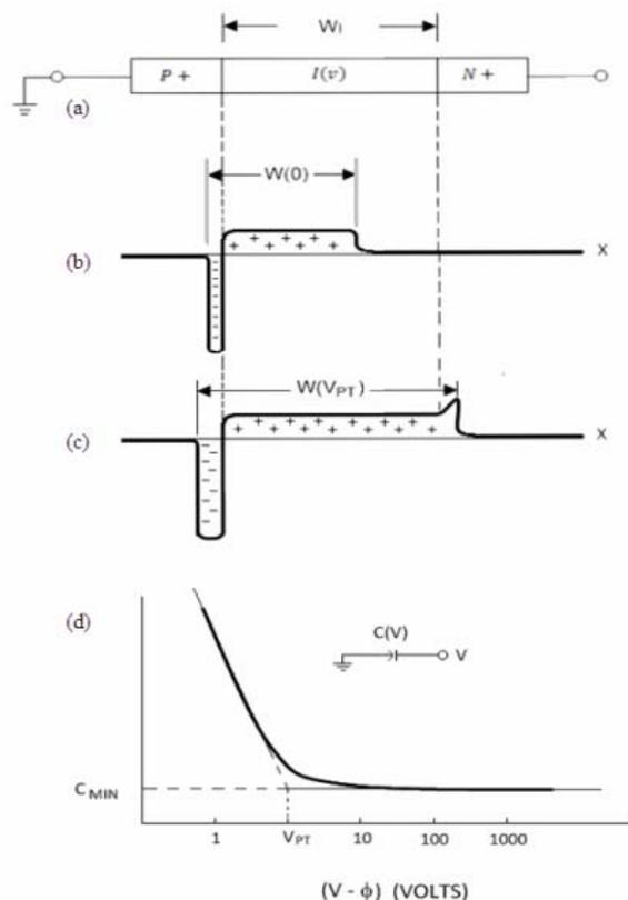
Fig. 3. Características del diodo *p-i-n* y su respuesta de voltaje de perforación. a) diodo *p-i-n* práctico, b) perfil de impurezas ionizadas en estado de polarización cero, c) perfil de impurezas ionizadas en estado de perforación, d) característica  $C(V)$  a 1 MHz [1].
