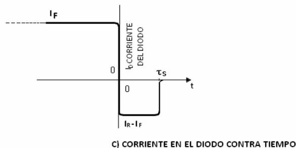
Fig. 5. Método de medición del tiempo de vida [2]
