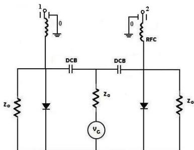
Fig. 10. Conmutadores SPDT con diodos en derivación [6].
