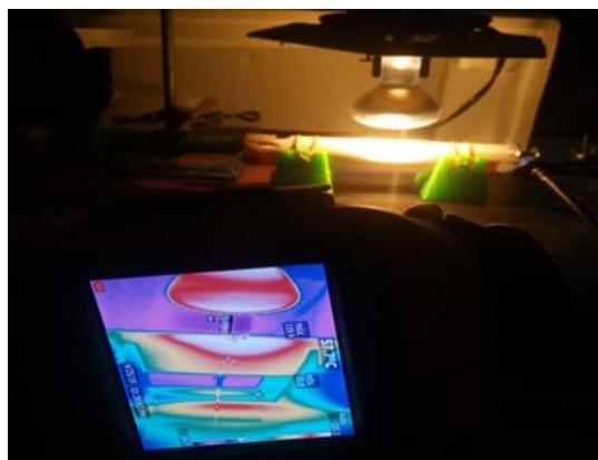
Fig. 2. Arreglo para la toma de temperatura con la cámara Fluke® Ti400
