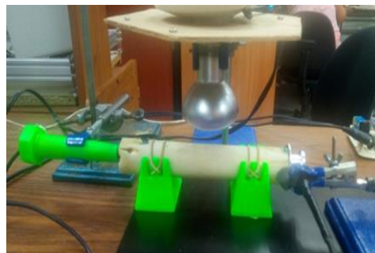
Fig. 1. Muestra de hueso vacuno colocada en el soporte para ser analizada
